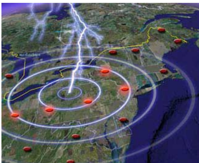
Figura 6.1 Il segnale prodotto da un fulmine viene ricevuto da diversi sensori e la localizzazione avviene confrontandone i dati
