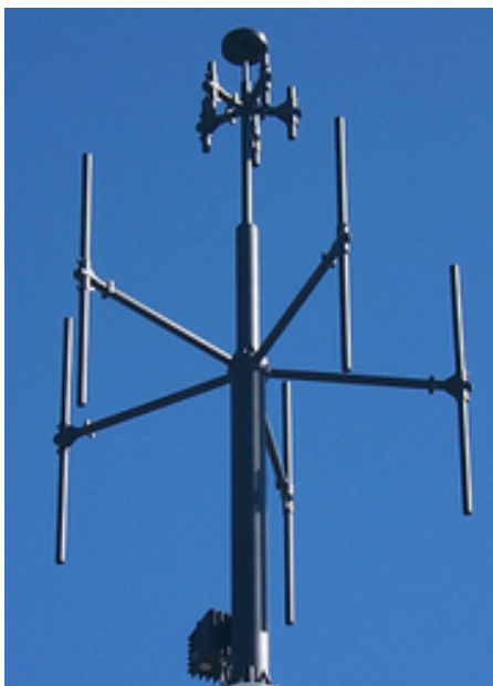
Figura 3.12 Le cinque antenne che costituiscono il sensore per l'utilizzo della tecnica interferometrica
