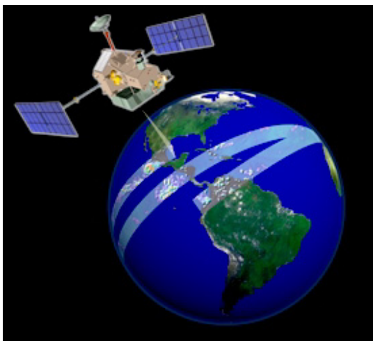
Figura 7.1 Un satellite orbitante spazza la superficie osservando ogni punto solo per pochi minuti ad ogni passaggio
