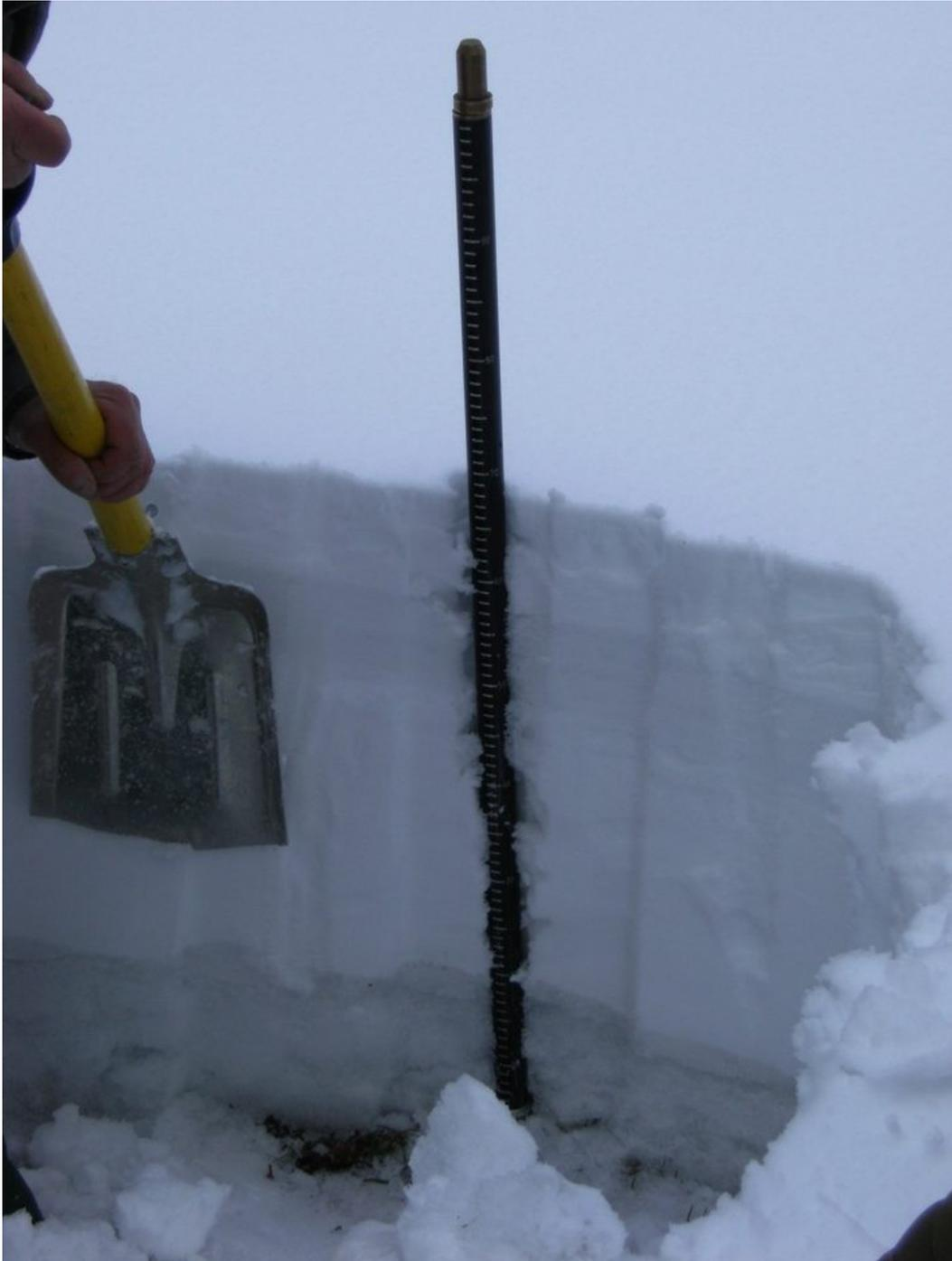
**Fig. 2.2** *Asta metrica, strumento tradizionalmente utilizzato per la misura dell'altezza del manto nevoso al suolo.*
