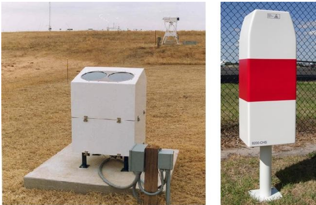
Figura 28: A sinistra cieliometro a tamburo ottico, a destra cieliometro laser.
