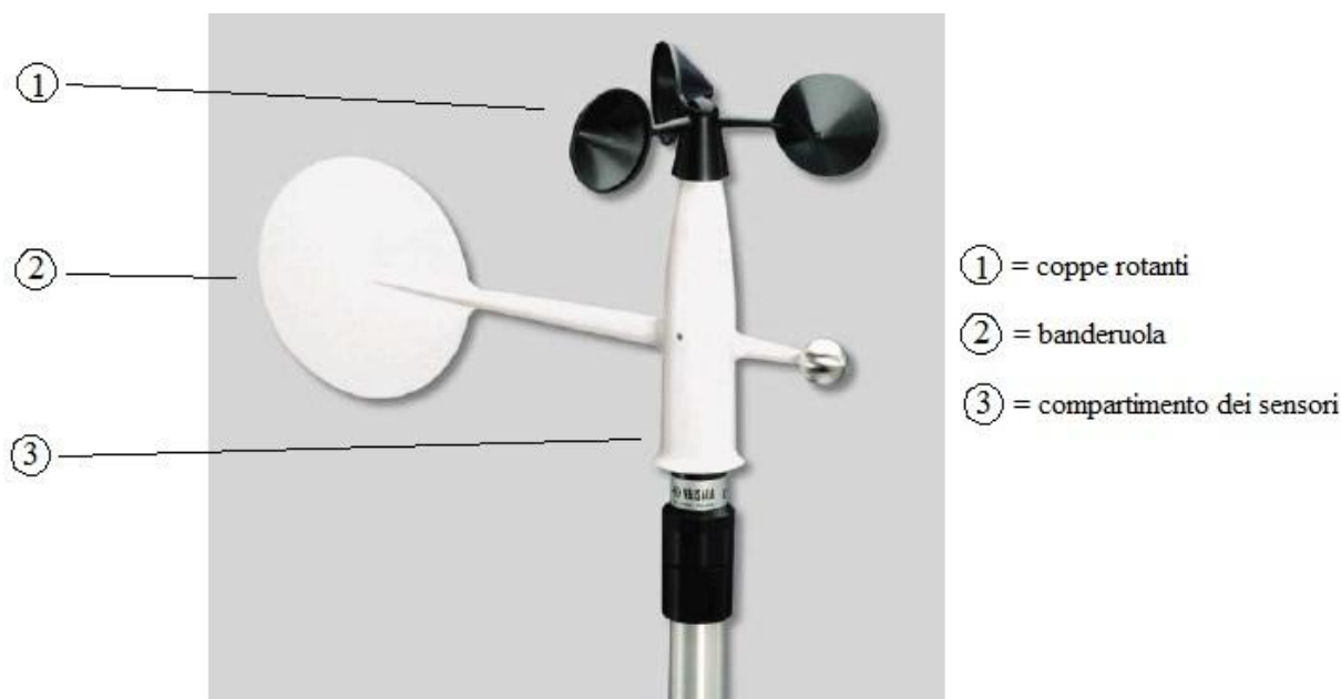
Figura 3.4 Anemometro Vaisala WM30 con i suoi componenti in evidenza.
