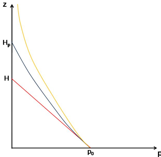
Figura 1: Andamento della pressione con la quota per i tre modelli di atmosfera analizzati. Linea rossa: atmosfera omogenea ( $\rho$  costante); linea gialla: atmosfera isoterma ( $T$  costante); linea blu: atmosfera politropica ( $dT/dz$  costante)
